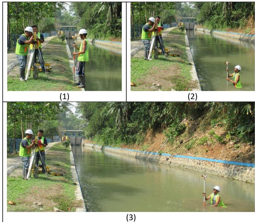
Gambar 1 Tahapan Pengukuran Penampang Saluran / Sungai
