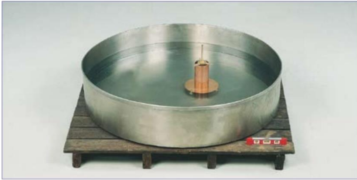
Gambar 1 (a) Panci evaporasi dan micrometer; (b) cara pembacaan mikrometer
